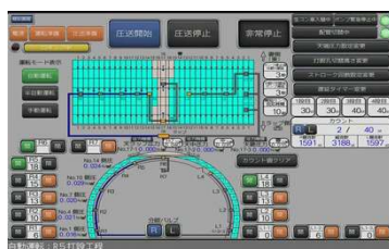
模擬トンネルで覆工コンクリートを自動打設中
