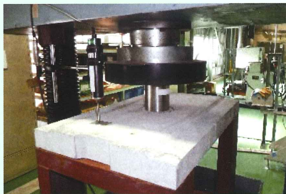
アロンブルコート® Z-X工法の押し抜き試験状況
