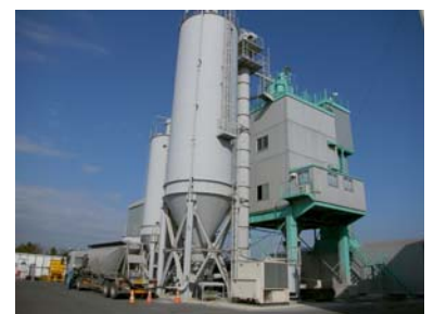
UFC専用のバッチャープラント (世界初のUFC専用プラント)
