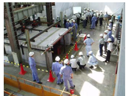
国交省様立会いのもと、載荷試験によりジャンボ機2機分の耐荷性能を証明
