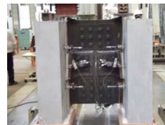
ジベル押し抜き試験
