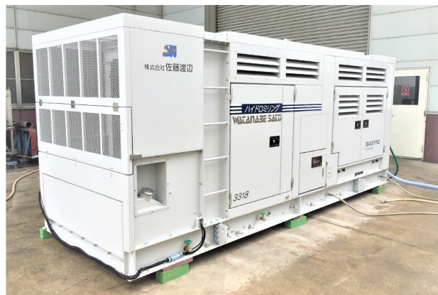
超高压水発生装置
